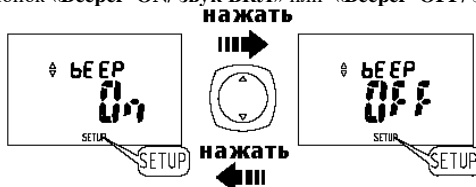
Рис.5.11 Функция отключения источника звукового сигнала
