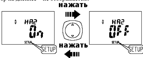
Рис.5.12 Функция Hazard – включена/ отключена.
