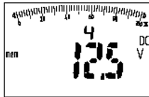
Рис.5.6 Результат на экране, вызванный из памяти (из ячейки №4)
