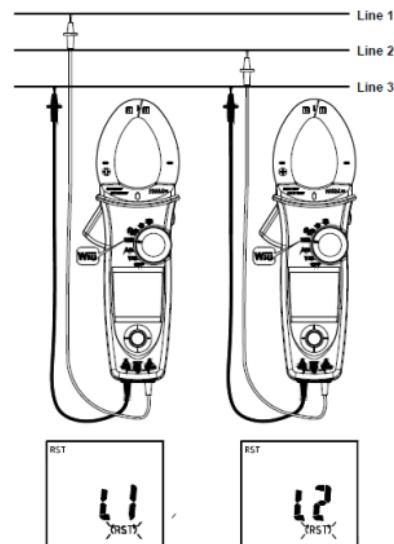
Рис. 8.6 Определение чередования фаз
