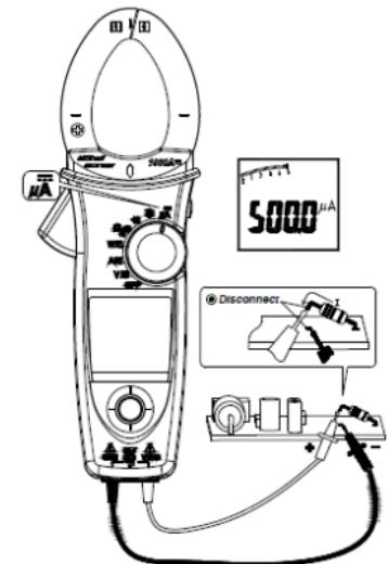
Рис. 8.10: Измерение пост. тока (мкА)
