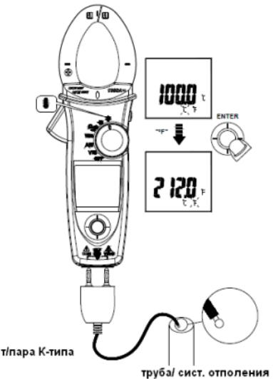
Рис. 8.9: Измерение температуры
