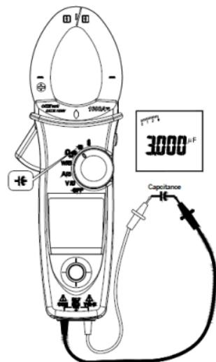
**Рис. 8.8:** Схема подключения емкости
