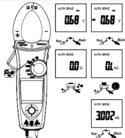
Рис. 8.7: Схемы подключения клещей
