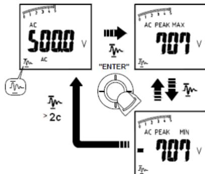
2. В режиме измерения переменного тока (ACA) выберите джойстиком на дисплее индикатор "  $\overline{\text{M}}$ " (анализ по горизонтали/ A) и затем нажмите ENTER более 2с для входа в режим регистрации пиковых значений тока (PEAK HOLD/ A).
