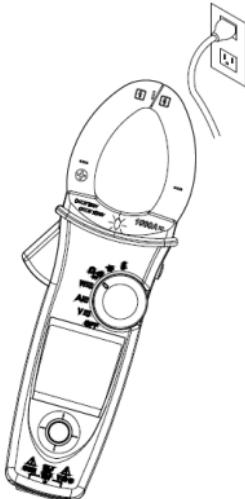
1. Режим *VoltSense* активируется в любом положении переключателя режимов (даже в положении Off/ ВЫКЛ).
